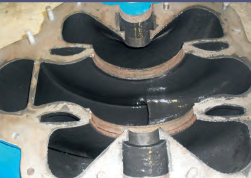
Här har pumphuset fått sin kompositbeläggning.
