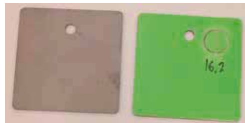
Provplåtar som använts för att testa om VCI-tekniken gör det möjligt att vänta med målning efter blästring. Hittills ser det lovande ut.
